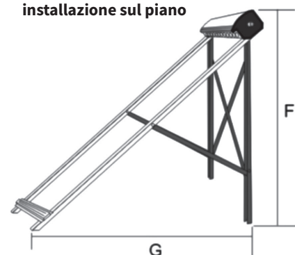
Telaio: installazione sul piano
